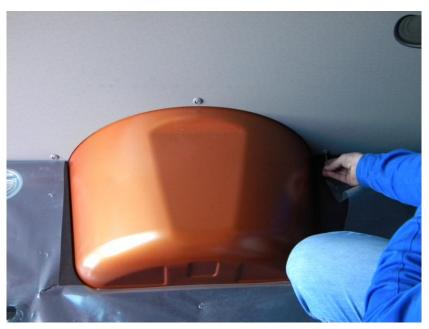
2. Накладываем защиту арки, следим чтобы нижние края накладки находились между обшивкой пола и аркой крыла, а боковое примыкание было плотным:
