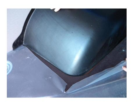
3. Отверстия в защите полностью совпадают с отверстиями для штатных креплений обшивки, таким образом Вы можете легко смонтировать штатный крепеж обратно, закрепляя им защиту арки:
