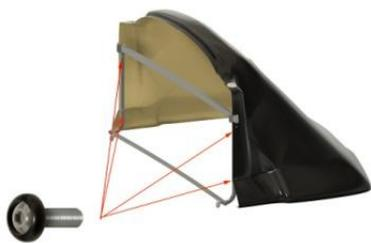
Распаковать обтекатель и положить тыльной стороной на упаковочный материал. Вставить раму в обтекатель, совместив отверстия на раме и обтекателе. Закрепить раму на обтекателе с помощью болтов М8х20 через пластиковую шайбу с первоначальным усилием не более 5Н·м (Рис. 1).
