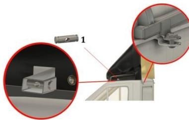
Собранную конструкцию установить на крышу автомобиля, таким образом, чтобы задняя планка рамы легла на водосток задней стенки кабины. Выровнять обтекатель по центру кабины. Притянуть раму обтекателя к водостоку с помощью задних зажимов и болтов М8х20 и равномерно затянуть с усилием 13 Н·м. Вставить поворотные гайки 1, как показано на рисунке
