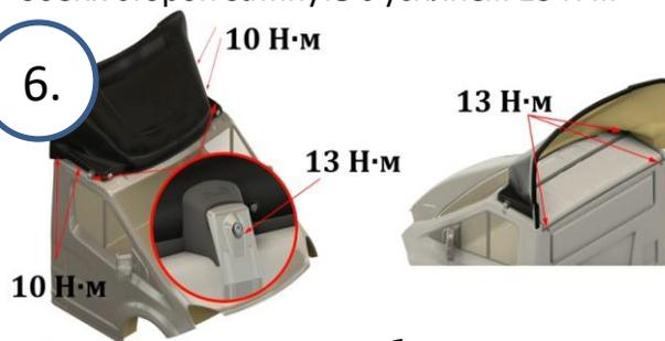
Равномерно притянуть болты крепления обтекателя к раме с усилием 10 Н·м. Через 1 час, после того как конструкция даст усадку, провести протяжку всех 8 болтов повторно.
