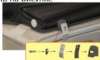
Надеть резиновый кожух узла крепления на выступающие концы рамы и закрепить прижимную лапку в месте с резиновым уплотнителем через болт М8х35 и шайбу пластиковую скользящую. Равномерно с обеих сторон затянуть с усилием 13 Н·м
